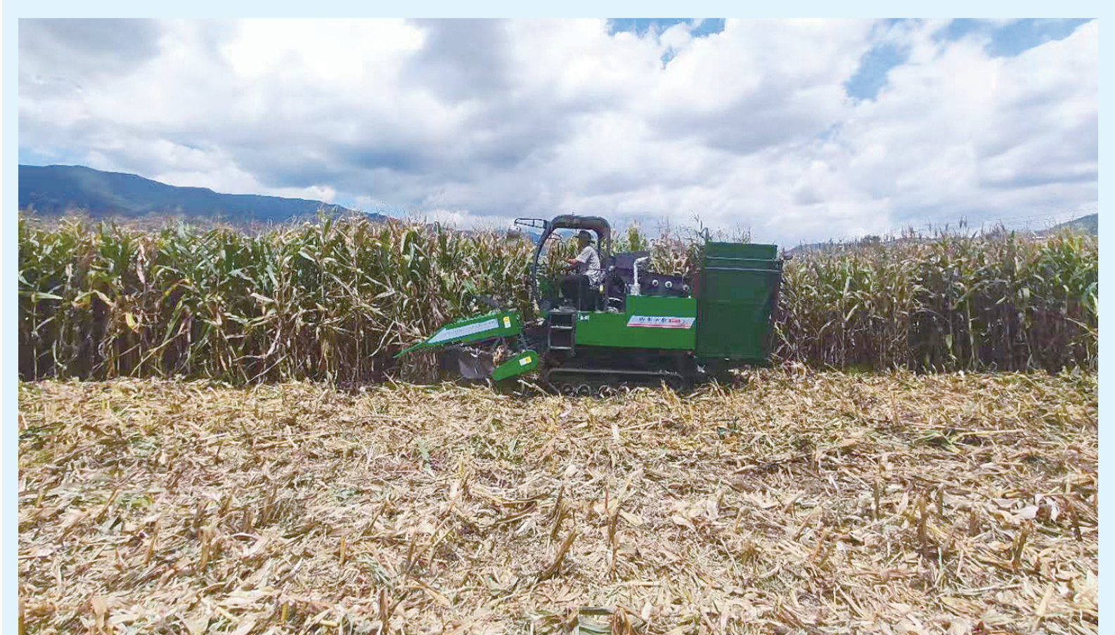
大理州农机管理总站开展玉米收获机现场演示作业,农机手使用玉米收获机一次性完成摘穗、堆集、茎秆还田等多项作业。(摄于9月2日)
