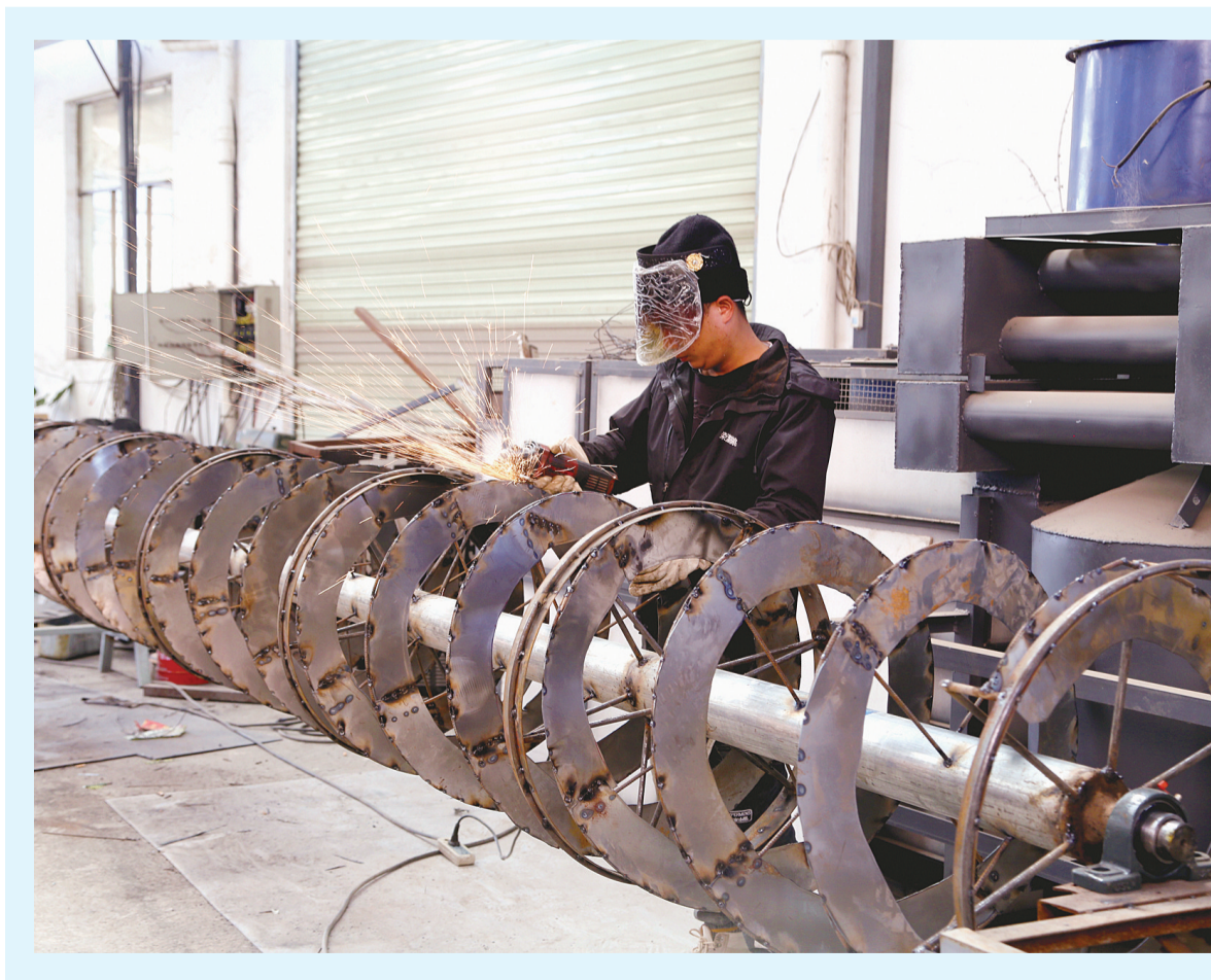
12月14日，漾濞县箐口核桃专业合作社生产车间内，工作人员正专心制作核桃筛选机配件。漾濞县箐口核桃初加工机械一体化生产线于今年9月正式完成调试并投入生产，核桃青皮加工和脱水等机械设备能达到日加工核桃青果60吨的最大产能设计要求，核桃干果、核桃仁、剥壳核桃仁机械都能达到单机加工工艺和生设计要，进一步提高了全县核桃初加工的能力和速度。 [特约记者 李灿美 摄]
